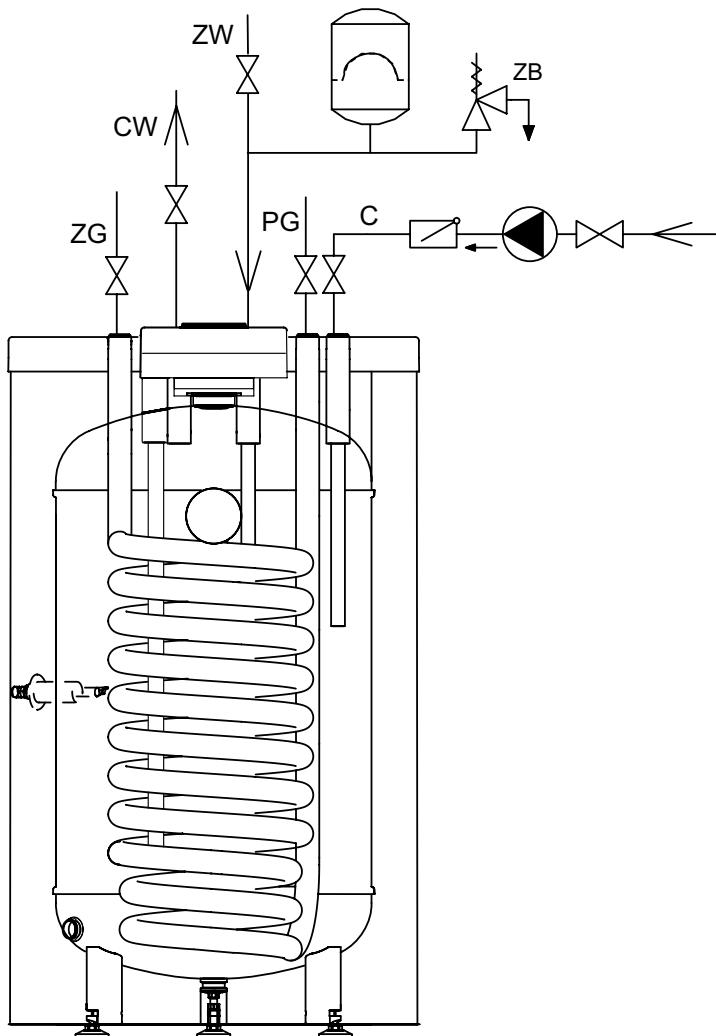
Подключение к сети водопровода следует осуществлять согласно обязывающим нормам. Теплообменник является напорным устройством, приспособленным для подключения к сети водопровода с давлением не превышающим 0,6 МПа. Если давление водопровода превышает уровень 0,6 МПа, то перед теплообменником следует установить редуктор давления.
