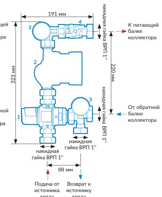
Глубина модулей с насосами - 95 мм
