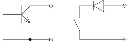
Аварийное состояние выходного каскада датчика при обнаружении протечки воды.
