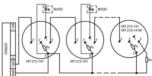
Если не требуется функция двойной сработки, то добавочный резистор  $R_d$  не устанавливается. При этом приемно-контрольный прибор должен иметь функцию ограничения тока в режиме «Пожар» до 20 мА во избежание выхода из строя извещателя.
