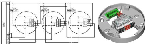
Извещатель обеспечивает возможность подключения выносного устройства оптической сигнализации (ВУОС).
