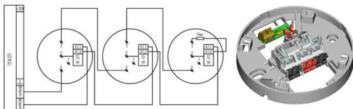
Извещатель может работать с приборами, имеющими четырехпроводную схему включения. Для этого используется устройство согласования УС-02. Оно устанавливается в корпусе штатной розетки извещателя.
