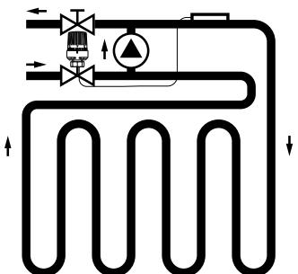
Используйте термостатическую головку M30x1,5 с накладным датчиком на подающем коллекторе для защиты системы от перегрева.
