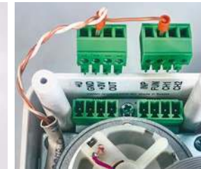
Фото 18. Подключение проводного выключателя к электроприводу
