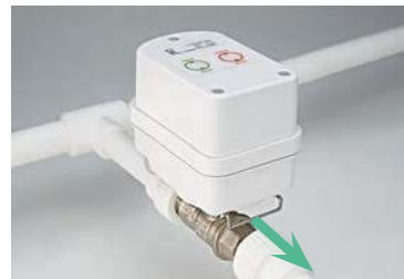
Фото 27. Удаление металлического фиксатора для отсоединения электропривода от шарового крана или ручного управления шаровым краном
