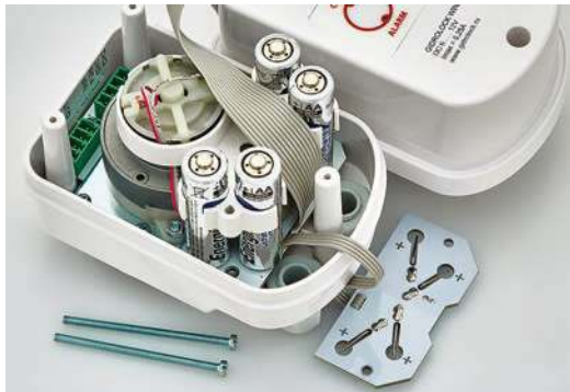
Фото 31. Контактная площадка снята, батарейки могут быть заменены
