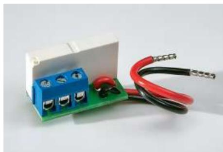
Выходной сигнал (перекидной контакт 1С): «сухой контакт» с нагрузочной способностью 5 А, 220 В.
