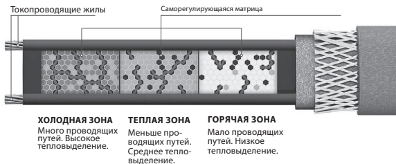
Рисунок 2. Принцип саморегулирования кабеля
