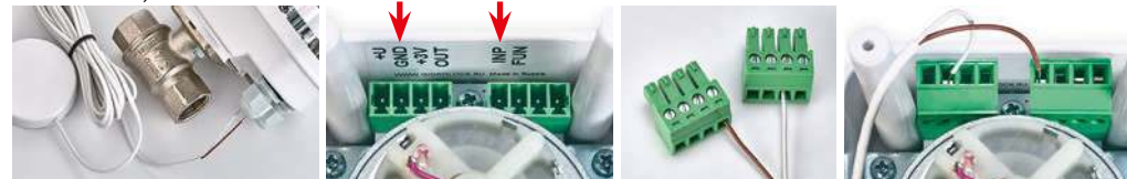
Фото 12. Завести провод датчика в кабельный ввод
