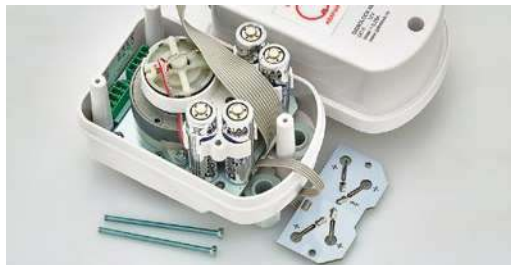
Фото 17. Контактная площадка снята, батарейки могут быть заменены
