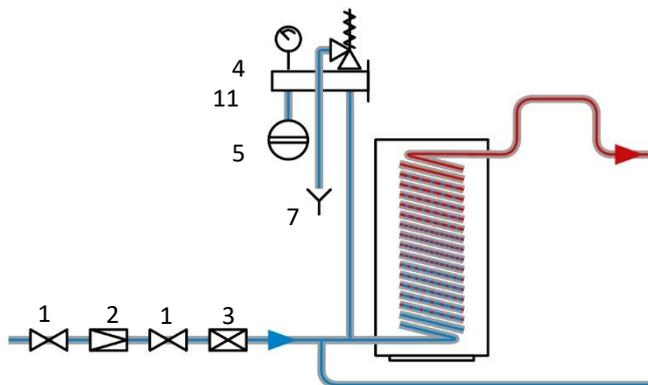
1 – запорный кран, 2 – редуктор давления VPR, 3 – обратный клапан, 4 – группа безопасности BSB, 5 – мембранный расширительный бак, 6 – бак для горячей воды, 7 – дренажный патрубок или охладитель,
