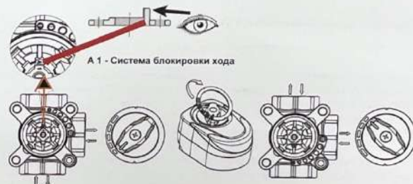
Схема настройки трехходового клапана в качестве смесительной арматуры
