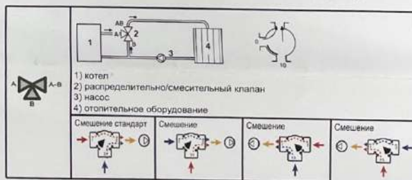
Схема настройки трехходового клапана в качестве распределительной арматуры
