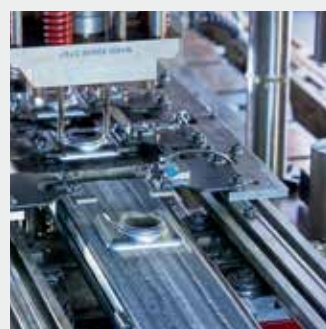
Точное изготовление половинок коллекторов
