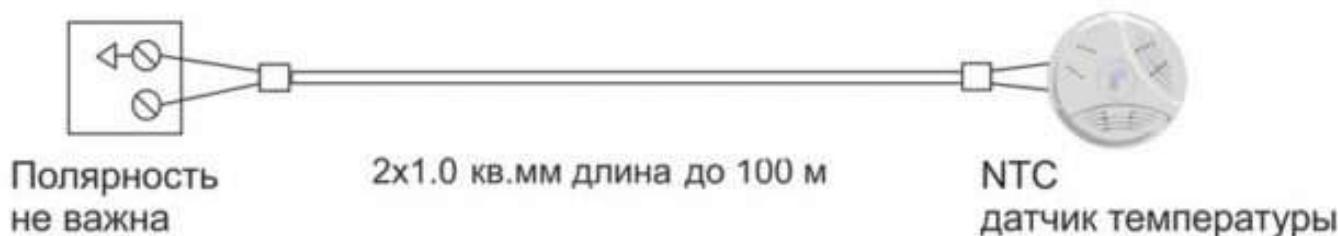
**Примечание:** Входы автоматических регуляторов ZONT CLIMATIC предварительно настроены на работу с этими датчиками и никаких дополнительных настроек не требуют.
