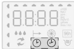
Значок часов будет отображаться при установке времени суток. Значок часов с "R" на нем будет отображаться при установке времени регенерации день.
