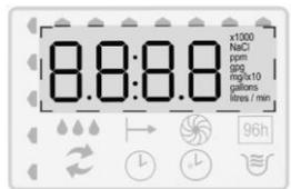
На главном экране отображается запас воды в галлонах (или литрах) до следующей автоматической регенерации. В среднем взрослый человек расходует 75 галлон (284 л) воды в сутки. Запас воды указывается в сотнях галлон (в сотнях или тысячах литров, в зависимости от значения). Например 88 = 8,800 галлон (33 = 3,300 или 33,000 литров если горит индикатор x
