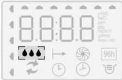
Индикатор водопотребления. Капельки «бегут» при протекании воды через умягчитель. Это удобно для контроля водопотребления и для обнаружения утечек воды.
