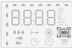
Режим 96 часов. Когда этот режим включен, регенерация будет происходить раз в четыре дня при отсутствии штатной регенерации в этот промежуток времени. Это нужно, чтобы извлеченное из воды растворенное железо не выпадало внутри умягчителя. При наличии в исходной воде растворенного железа и / или марганца режим «96h» должен быть включен.
