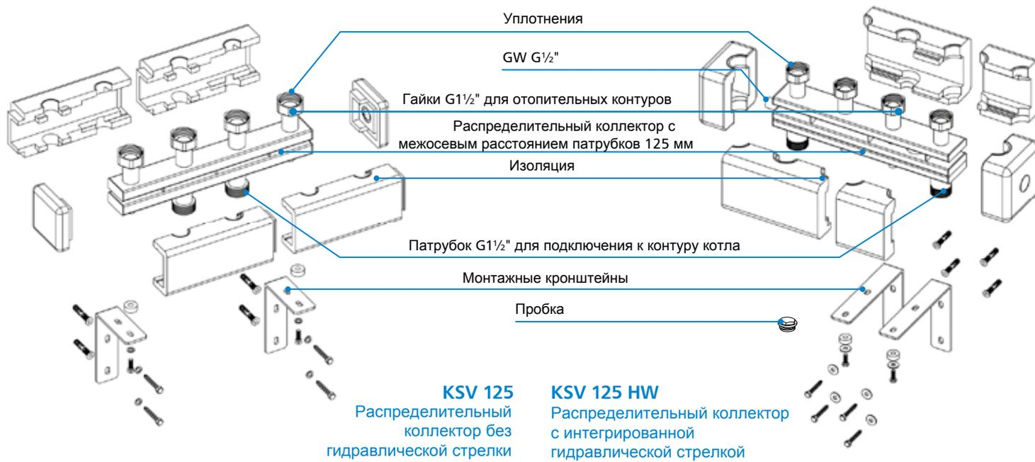
Распределительные коллекторы KSV 125 используются для распределения теплоносителя. Контуры отопления необходимо соединить с патрубками с резьбой G1 1/2" с использованием прокладок из комплекта. Также необходимо уплотнить соединение с контуром котла.
