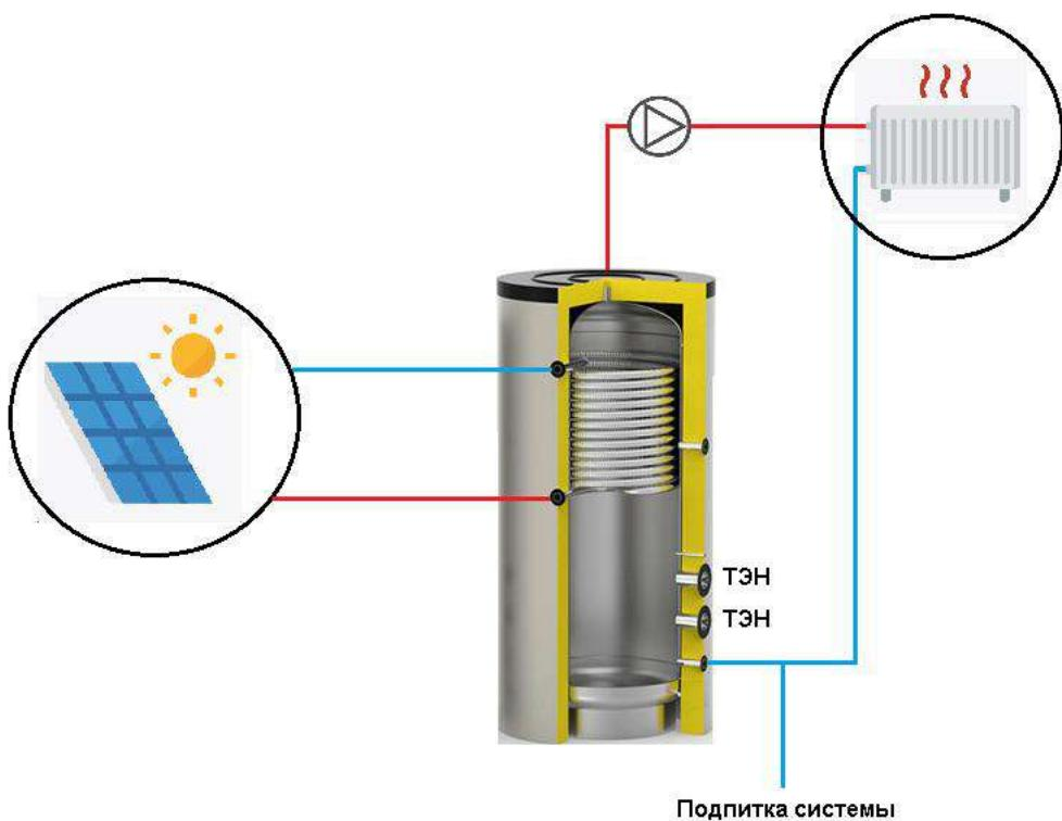
Область применения: - Накопление и аккумулирование нагретой технической воды.
