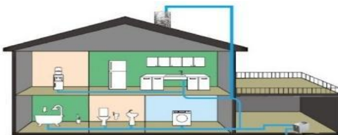
Рис. 2. Схема водоснабжения насосной станции S-BOX4-30
