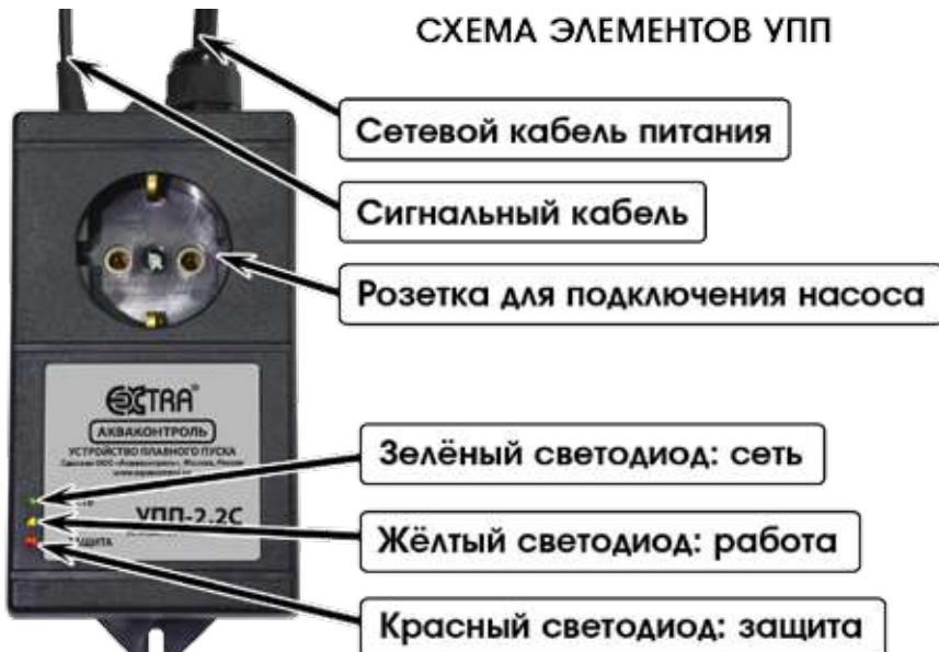
В **УПП-2,2С** использован экспоненциальный график увеличения напряжения на нагрузке. Такой способ, в отличие от общепринятых линейных графиков, позволяет быстро и плавно запустить/остановить электродвигатель насоса без перепадов тока и перегрузок.
