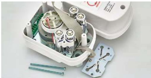
Фото 17. Контактная площадка снята, батарейки могут быть заменены
